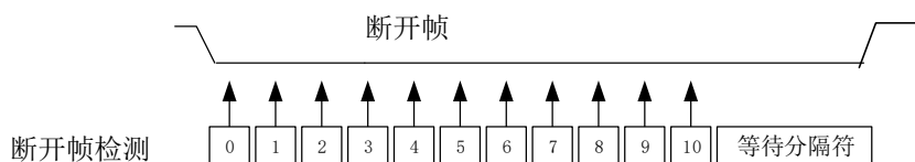
图 30-19 LIN模式下的断开帧长度够的情况
