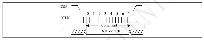
Figure 10-39a Chip Erase (CE) Sequence (QPI)
