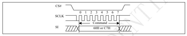
Figure 10-30a Chip Erase (CE) Sequence (QPI)
