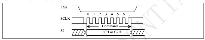
Figure 10-30a Chip Erase (CE) Sequence (QPI)
