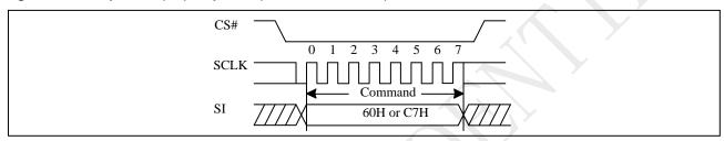
Figure 10-30a Chip Erase (CE) Sequence (QPI)
