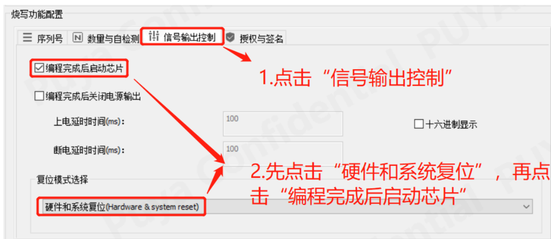
图 11-3 创芯工坊操作勾选“编程后重启芯片”
