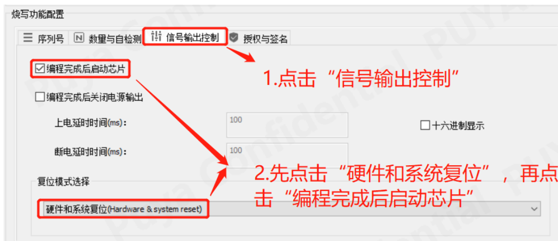
图 15-3 创芯工坊操作“编程后重启芯片”
