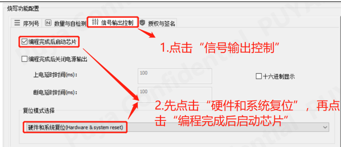
图 18-4 创芯工坊操作勾选“编程后重启芯片”
